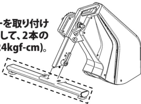
2. 5mmの六角レンチを使用して、ショルダーボルトの締め付けを調整します。
