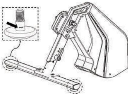
注意：破損を防ぐため、フットボルトのMAX表示がスタビライザーの外に出た状態(=ネジ部のかかり代が少ない状態)は避けてください。
